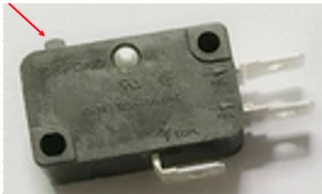
Ce qu'il faut retenir de ces départs Electriques servis par une platine Electronique et un micro contacteur (micro switch flèche rouge)
